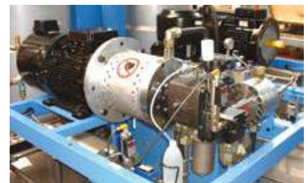
Не требующая обслуживания герметизация дозировочных насосов литьевых машин высокого давления для полиолов и изоцианатов.
